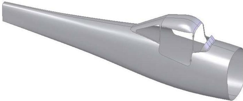
Figura 20-23 – Fuselagem da Aeronave (Fibra de Vidro)
