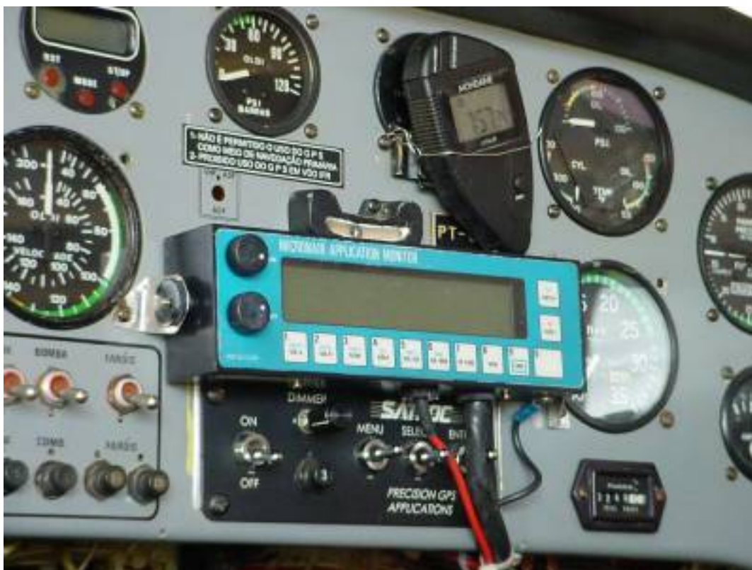
FIGURA – Monitor de aplicação MICRONAIR no painel da aeronave
