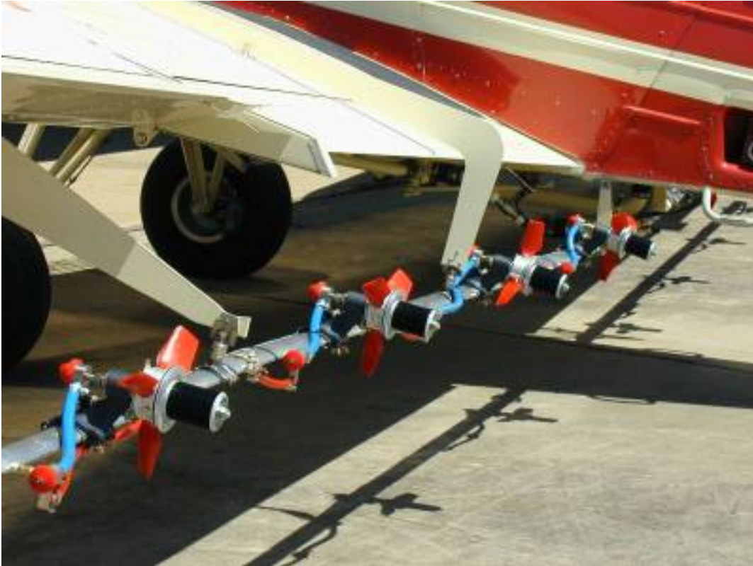
FIGURA – INSTALAÇÃO E POSICIONAMENTO DOS MICRONAIR
