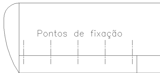
Figura 17.3- Localização e pontos de fixação do aileron
