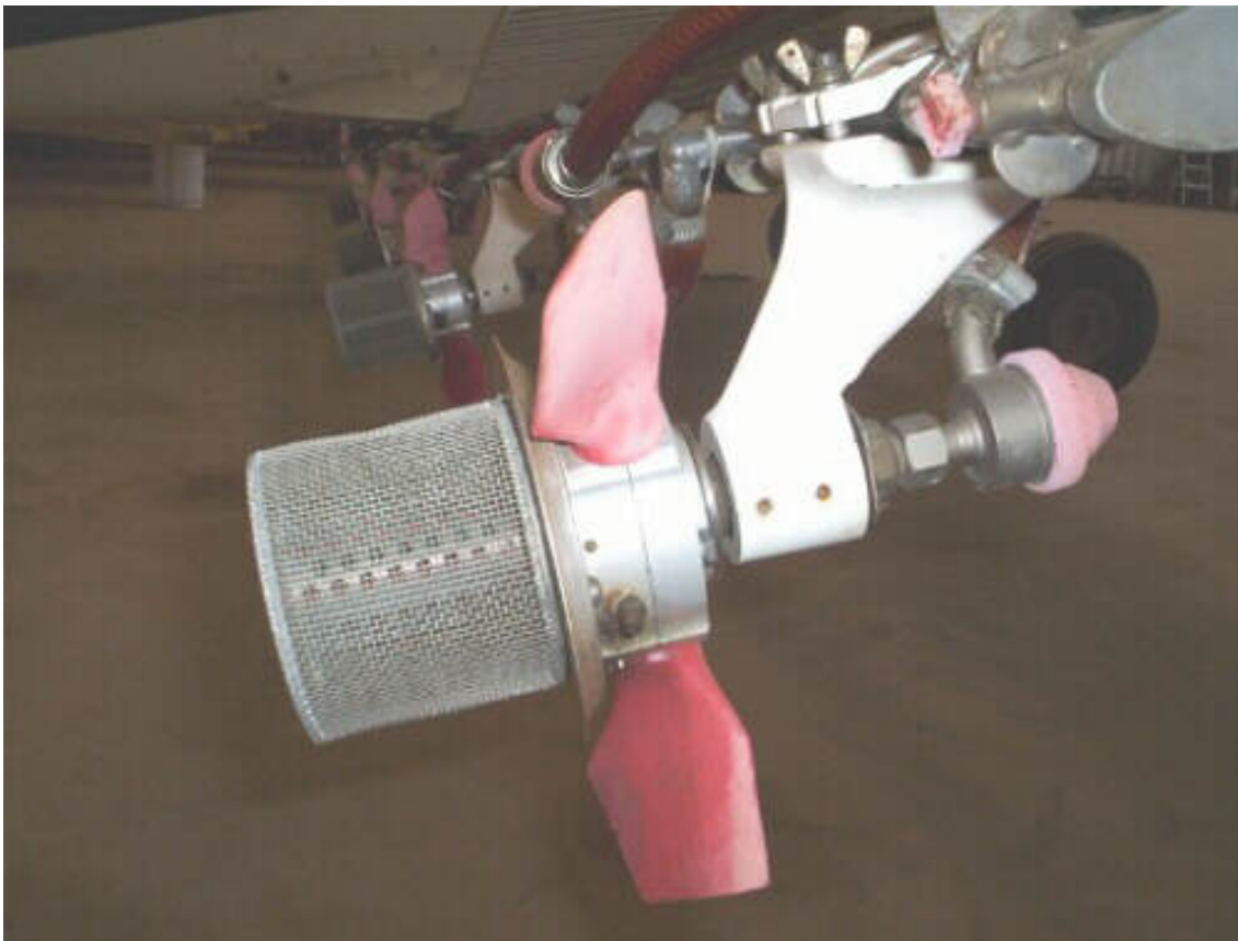
FIGURA – FOTO ILUSTRATIVA DO MICRONAIR INSTALADO EM UM IPANEMA
